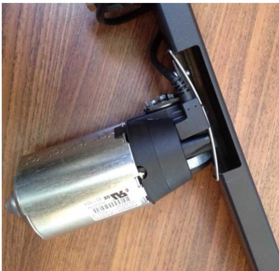
6.1.3 Monteer de veer voor de borging van de motorstekker.
