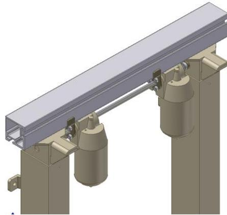
7.1.8 Die rechte Montagekonsole in die Fräsung auf der Unterseite des Aluminiumprofils schieben und mit 2 Bolzen befestigen.
