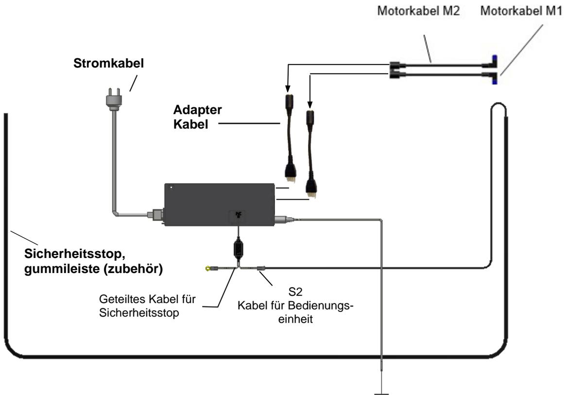
7.8.2 Die Stecker für Motor und Netzspannung in der Steuereinheit einstecken. Für den Anschluss Sequenz siehe Start-up-Verfahren auf Seite 20.
