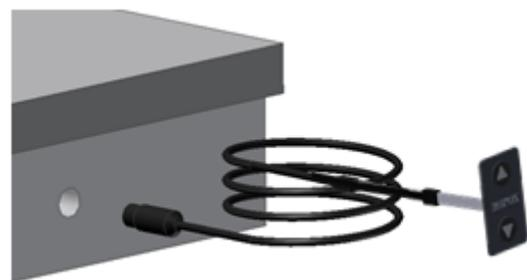
7.9.1 Der Bedienungstaster für die Höhenverstellung muss in der Holzvorderzarge montiert werden. Er besteht aus einem Bedienungstaster und einem 1,5 m langen Kabel mit fünfpoligem DIN-Stecker für die Steuerung.
