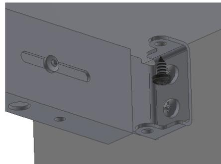
7.6.2 Durch Einschrauben der Beschläge in der Auflageplatte wird die Vorderzarge nach oben gezogen. Zuletzt die Schrauben auf der Seite der Konsole anziehen.
