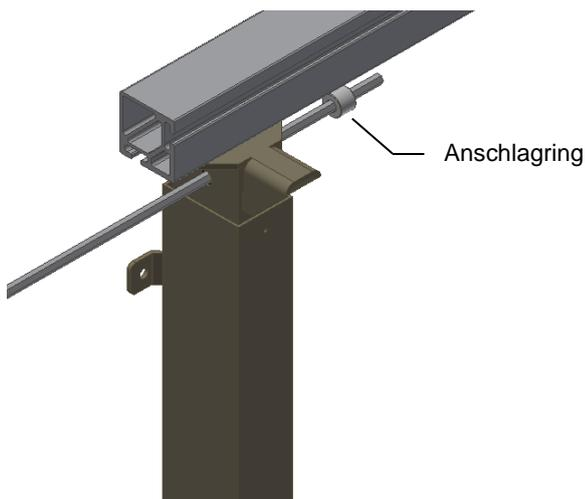
7.1.3 Die Welle/Spindel durch die Montagekonsole in der linken Seite schieben. Den Anschlagring auf die Welle schieben, sodass diese gegen die Montagekonsole wendet.
