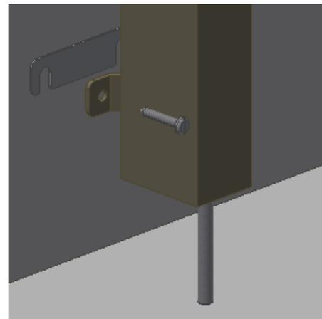
7.2.2 Wandunebenheiten von bis zu 0,45 cm können durch Montage der mitgelieferten Unterlegplättchen (0,15 cm) zwischen den Montagekonsolen und der Wand ausgeglichen werden. Die Montagekonsolen ein wenig lockern und, falls erforderlich, die Unterlegplättchen (0,15 cm) oben oder unten hinter die Befestigungslaschen der Montagekonsolen schieben.
