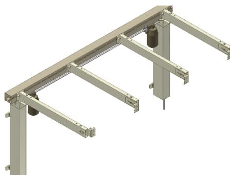
7.1.10 Die äußerste rechte Plattenauflegekonsole von der rechten Seite auf das Aluminiumprofil schieben. Diese Auflagekonsole muss immer direkt über der rechten Montagekonsole angebracht werden.
