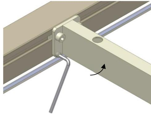
7.5.2 Mittels der beiden unteren Schrauben der Auflageplattenkonsolen kann die Auflageplatte ausgerichtet werden. Zuerst die beiden Schrauben für Befestigung der Auflageplattenkonsole am Aluminiumprofil lockern und die unteren Schrauben justieren, bis die Auflageplatte waagrecht ist. Danach die beiden oberen Schrauben nachziehen. Diesen Vorgang für die Auflageplattenkonsole in der Mitte wiederholen.
