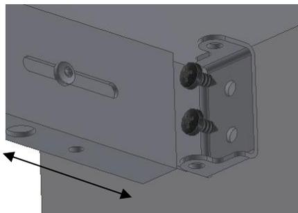
7.6.1 Die Holzvorderzarge in der gewünschten Position unter der Auflageplatte mit einer Klemmzange festsetzen. Die Vorderzargenbeschläge gegen die Vorderzarge drücken und von innen befestigen.
