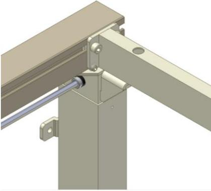
7.1.11 Die Anschlagringe auf der Welle/Spindel zu beiden Seiten bewegen sodaß diese gegen die Montagekonsolen wenden. Die Schrauben in Anschlagringen festschrauben und sichern.
