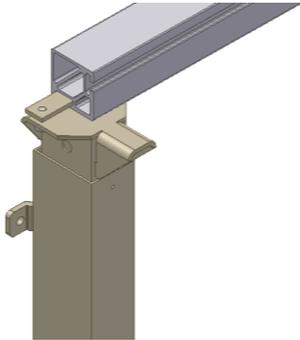
7.1.1 Die Montagekonsole in die Fräsung auf der Unterseite des Aluminiumprofils schieben.
