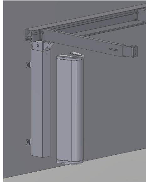
7.11.1 Die 2 Endplatten auf die Abdeckungen setzen und danach über die Montagekonsole schieben.
