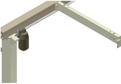
7.1.5 Jetzt alle Plattenauflegekonsolen mit der Ausnahme von 2 Stück von der rechten Seite auf das Aluminiumprofil schieben und so verteilen, dass der jeweilige Abstand zwischen den Auflagekonsolen nicht 60 cm übersteigt.
