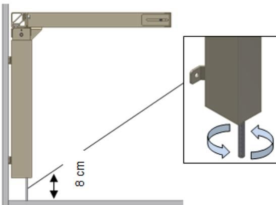
7.2.1 Den Flexi an die Wand anbringen und nach dem Lot ausrichten. Die beiden Stellschrauben unter den Montagekonsolen so einstellen, dass der Rahmen waagrecht ist.
