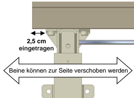
7.1.2 Die Konsole 2,5 cm von der Innenseite des Aluminiumprofils anbringen und mit 2 Bolzen befestigen. Sollten sich vor der Montagekonsole Steckdosen befinden, kann die Konsole ein wenig gegen die Mitte verschoben werden. Bei Rahmen mit zwei Montagekonsolen ist auf jeder Seite eine Konsole zu montieren. Hat der Rahmen drei Montagekonsolen, ist die dritte Konsole in der Mitte des Aluminiumprofils anzubringen.
