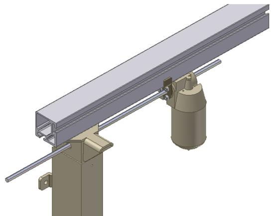
7.1.4 Den Motor mit Beschlag auf die Welle/Spindel schieben. Ist der Motor mit der Montagekonsole nicht parallel, den Motor zur senkrechten Position drehen. Siehe 7.1.7
