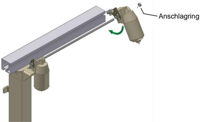
7.1.7 Für Arbeitsplattenlängen 105-300 cm muss ein zusätzlicher Motor wie beschrieben montiert werden. Die Abstandsscheibe und den Anschlagring zwischen Motor und Montagekonsole auf der rechten Seite so anbringen, dass die Abstandsscheibe immer gegen die Konsole gekehrt ist.
