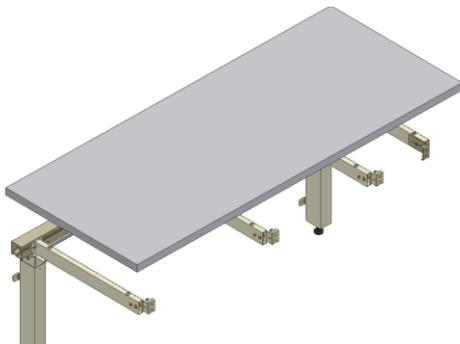
7.4.1 Die Plattenaufgabe auf dem Rahmen anbringen. Der höchst zulässige Abstand von der Hinterkante der Auflageplatte bis zur Wand beträgt 0,5 cm. Wird der Rahmen von der Wand weggerückt, MUSS der Abstand zwischen Wand und Hinterkante Auflageplatte immer noch gleich oder kleiner als 0,5 cm sein. (unabhängig davon, ob ein Abstand-halter verwendet wurde oder nicht).
