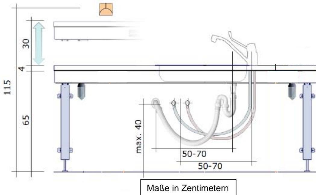
Der schraffierte Bereich steht für Wasseranschluss und Ablauf zur Verfügung. Alle Schläuche für Zu- und Ableitungen müssen flexibel sein. Dadurch bewegt sich der Flexi ungehindert innerhalb des Höhenverstellbereiches von 68-98 cm einschl. Waschbecken.
