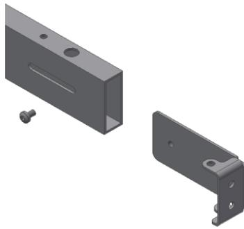
7.3.1 Beschläge entsprechend der Anzahl der Auflageplattenkonsolen werden zur Montage der Holzvorderzarge mitgeliefert. Den Beschlag auf der Seite der Auflageplattenkonsole anbringen und mit der mitgelieferten Schraube lose befestigen.
