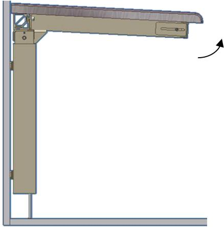
7.5.1 Nach Belastung des Rahmens mit der Auflageplatte kann ein Ausrichten notwendig sein, falls der Rahmen von der Wand bis zur Vorderzarge nicht länger waagrecht ist.
