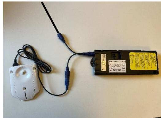
8.7.2 Schlitzkabel in den "HS"-Anschluss des Steuergeräts stecken. Dann den Adapter in das eine Ende einstecken, und die mitgelieferte Handbedienung in das andere Ende
