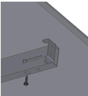
7.4.3 Die Auflageplatte durch die Löcher der Konsolen mit Schrauben befestigen.
