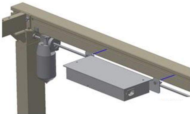
7.8.1 Die beiden speziellen Schraubenmütter der Steuerungsplatte horizontal wenden, so dass sie längs in die Spur von dem Aluminiumprofil passen. Die Platte auf der Vorderseite des Aluminiumprofils platzieren und die M6 Schrauben anziehen (die speziellen Schraubenmütter drehen sich automatisch zu Recht, wenn die Schrauben angezogen werden).
