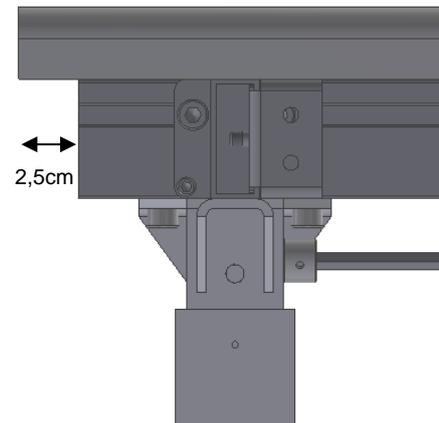
7.4.2 Das Aluminiumprofil ist standardmäßig 5 cm kürzer als die Auflageplatte, wodurch auf jeder Seite der Auflageplatte ein Überstand von 2,5 cm erreicht wird.
