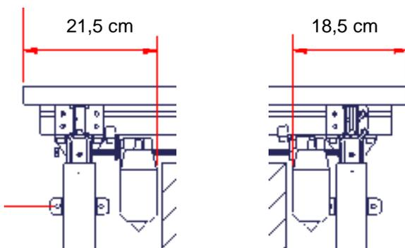
7.1.9 Die Motoren in dem angegebenen Abstand von beiden Enden des Aluminiumprofils anbringen und befestigen.
