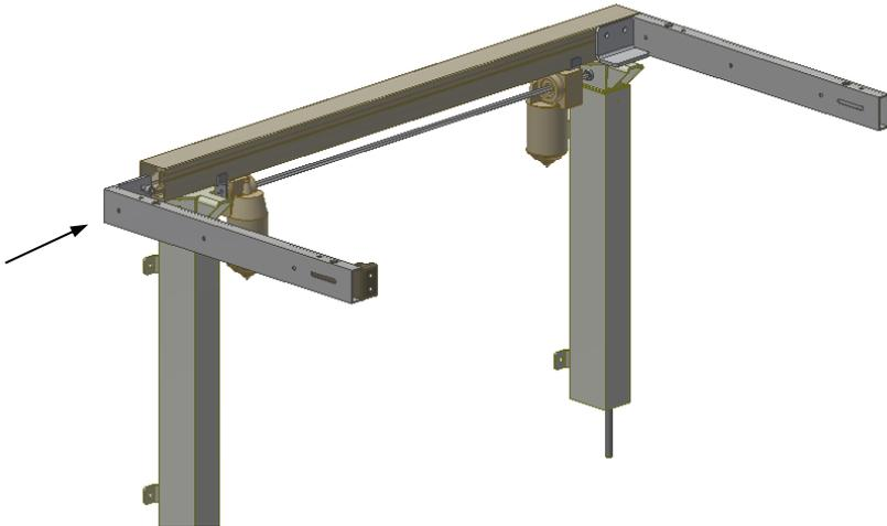
8.6.1 Die Auflagekonsole in das Aluminiumprofil schieben, sodass die Auflagekonsole waagrecht mit dem Aluminiumprofil ist. Danach die Schrauben anziehen. Bei Anwendung von dieser Montagekonsole, ist es möglich Kochplatte oder Spülbecken dichter an der Tischplattenkante zu montieren.
