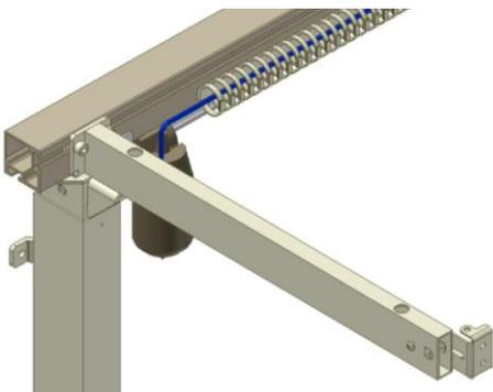
7.8.3 Die losen Kabel in den Kabelträgern einbringen und den Träger an dem Aluminiumprofil befestigen.
