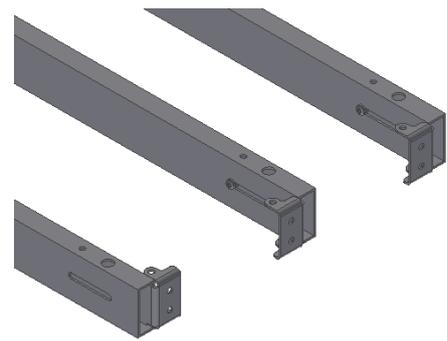
7.3.2 An den äußeren Auflageplattenkonsolen sollten die Beschläge nach der Mitte des Rahmens orientiert werden, damit sie nicht mit der Seitenzarge in Konflikt geraten.
