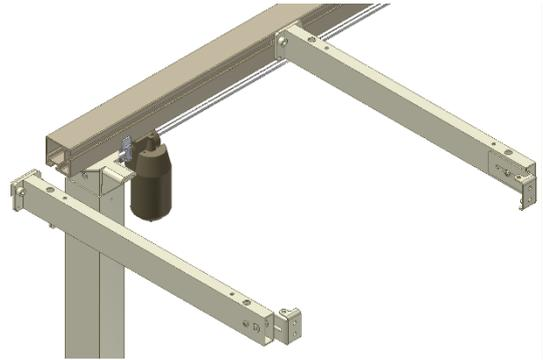
7.1.6 Die linke Plattenauflegekonsole auf das Aluminiumprofil schieben. direkt über die linke Montagekonsole platzieren und befestigen.
